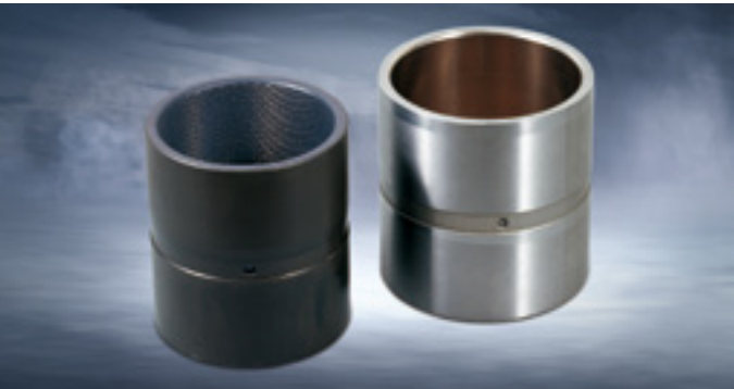
Buje Para el pivote de la pluma se utiliza un buje de metal de alta lubricación, con el fin de incrementar la vida útil y extender los intervalos de lubricación a 250 horas. Un tipo de buje de rodillo con surcos muy precisos se ha agregado al brazo y al pivote de la cuchara; de tal manera que la lubricación es requerida solamente cada 50 horas.
