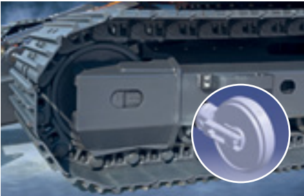
Resorte de orugas y rueda guía integrados El resorte de orugas y la rueda guía han sido unidos en forma directa para lograr una mayor durabilidad y favorecer el mantenimiento.
