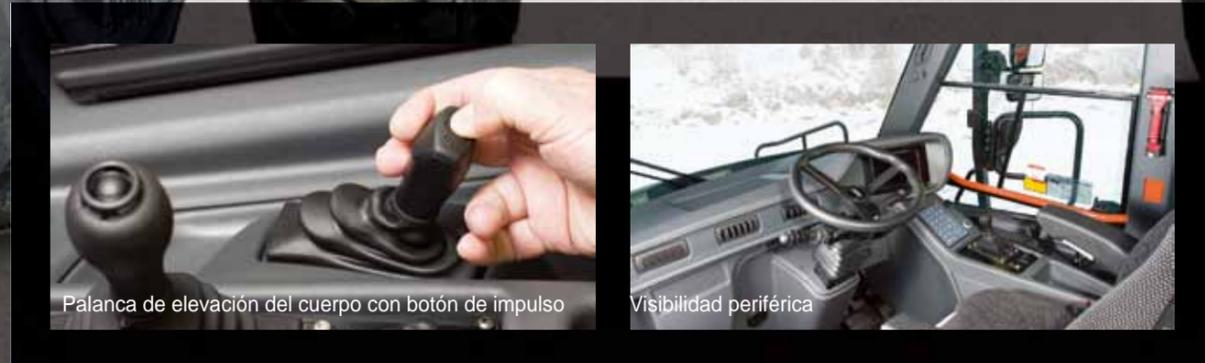
Palanca de elevación del cuerpo con botón de impulso
